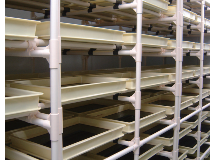
自然乾燥による濃縮工程
