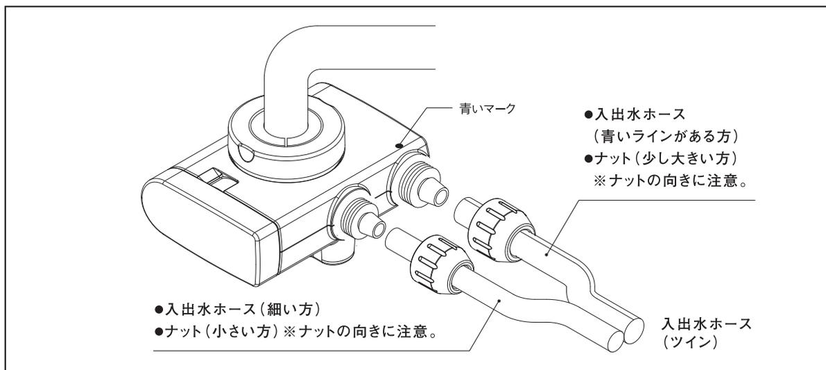
必要に応じて付属の固定バンドでホースを固定してください。(P.14設置図参照)
