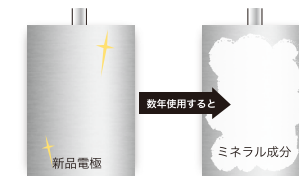
※4000時間使用した後の電極 ※新品の時の電極の状態
